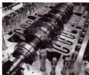
Compresor carcasa partida + barril forjado gas lift
