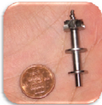
La turbina a GAS mas Pequeña Velocidad de Giro hasta 600.000 rpm Potencia 5 KW (energía necesaria para alimentar 2 casas) Temp: 1200K
